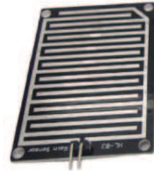
Gambar 9.57 Modul Sensor Hujan
